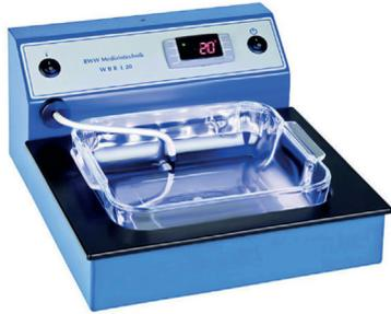
Eckiges Wasserbad mit eingebauter seitlicher Beleuchtung.
