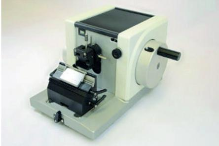
Mikrometerwerk und Grobtriebssystem im geschlossenen Gehäuse.
