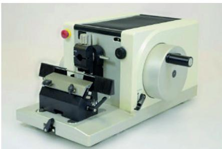
Das Mikrotom ist mit einem elektronischen Motorantrieb ausgerüstet. Dies erleichtert die Bedienung bei lang andauernden Schnittfolgen erheblich. Das Schneiden kann entweder am Bedienterminal oder an einem (optimal) Fußschalter gestartet werden. Geschnitten werden kann in 3 Variationen am Handtableau:
