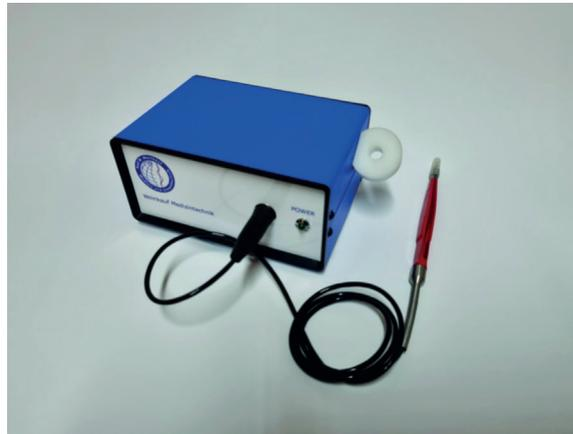
Passend zu der Pinzetten-Station können sie Pinzetten in den Größen von 0,5mm bis 4mm anschließen. Die einzelnen Pinzetten sind, zur einfachen Orientierung, je nach Größe farblich markiert. Alle Pinzetten werden nur an der Spitze auf ca. 68 Grad erhitzt. Das Anschlusskabel ist hitzebeständig bis 80 Grad, hoch- flexibel, und resistent gegen Paraffin. Es können zwei verschiedene Pinzetten gleichzeitig betrieben werden.
