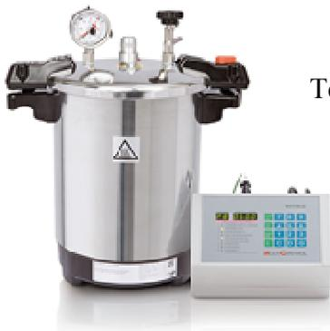
Temperatur frei steuerbar von Zimmertemperatur bis 140 C (2,7 Bar)
